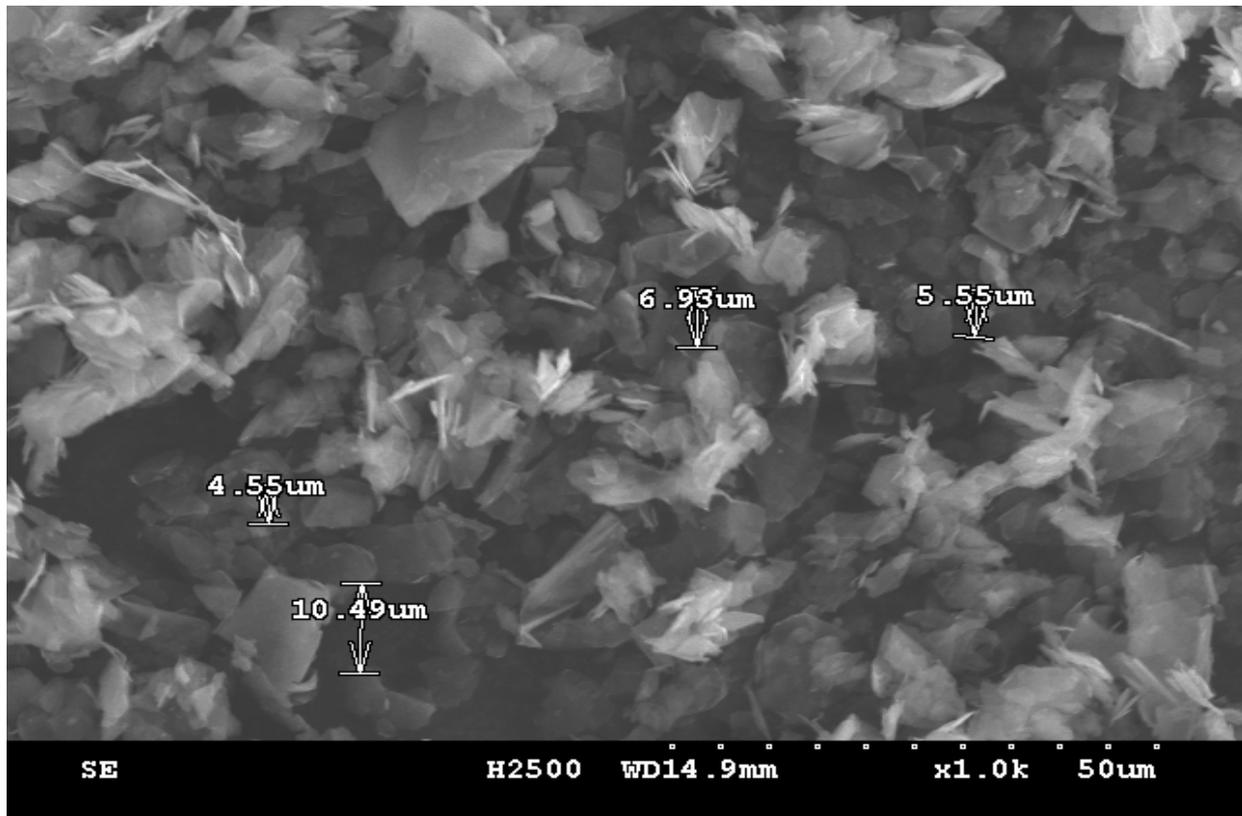
圖二 石墨粉 2500 目 電子顯微鏡(SEM) 1000 倍放大圖
