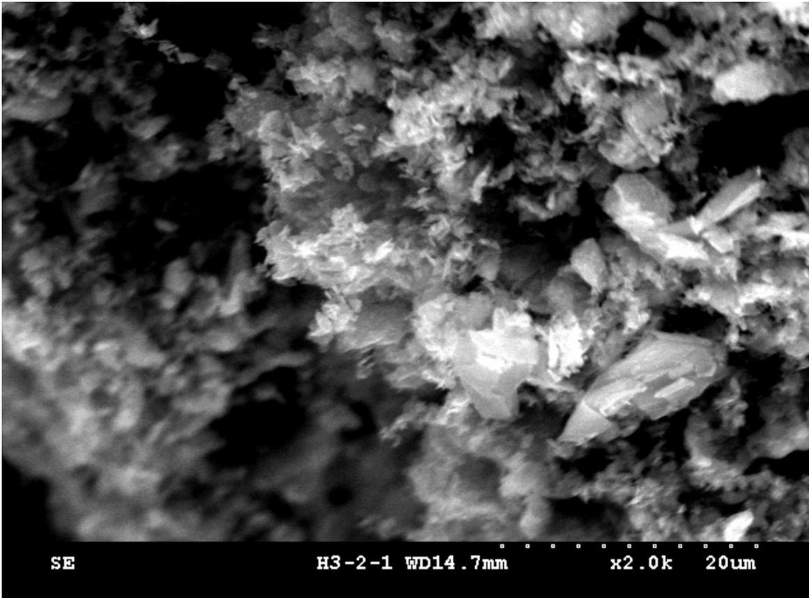
圖八 石墨粉 3.2micron 電子顯微鏡放大圖 2000 倍
