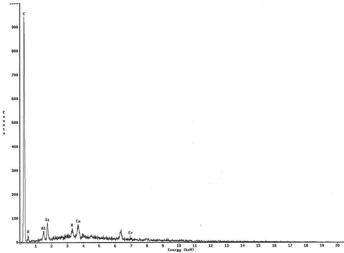
圖九 石墨粉 3.2micron 材質分析圖(EDS)
