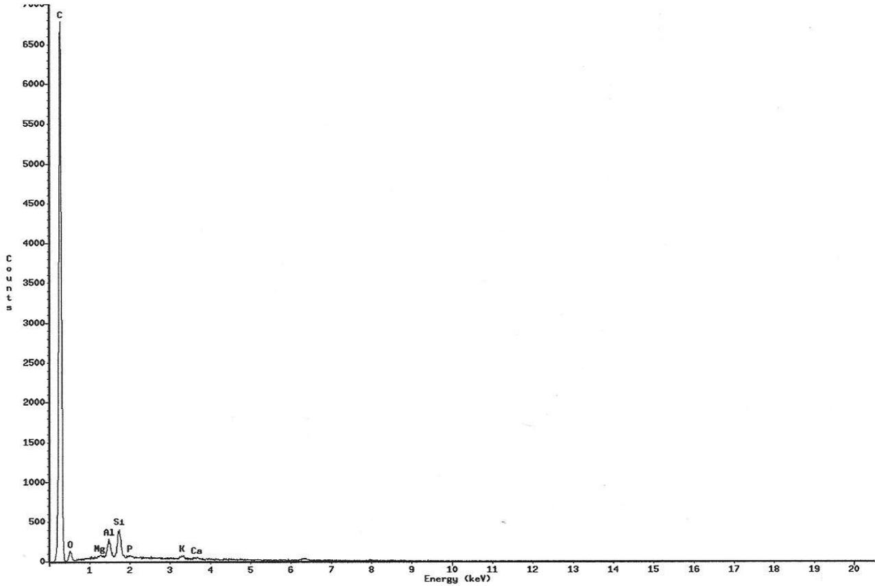
圖六 石墨粉 3.2micron 材質分析圖(EDS)
