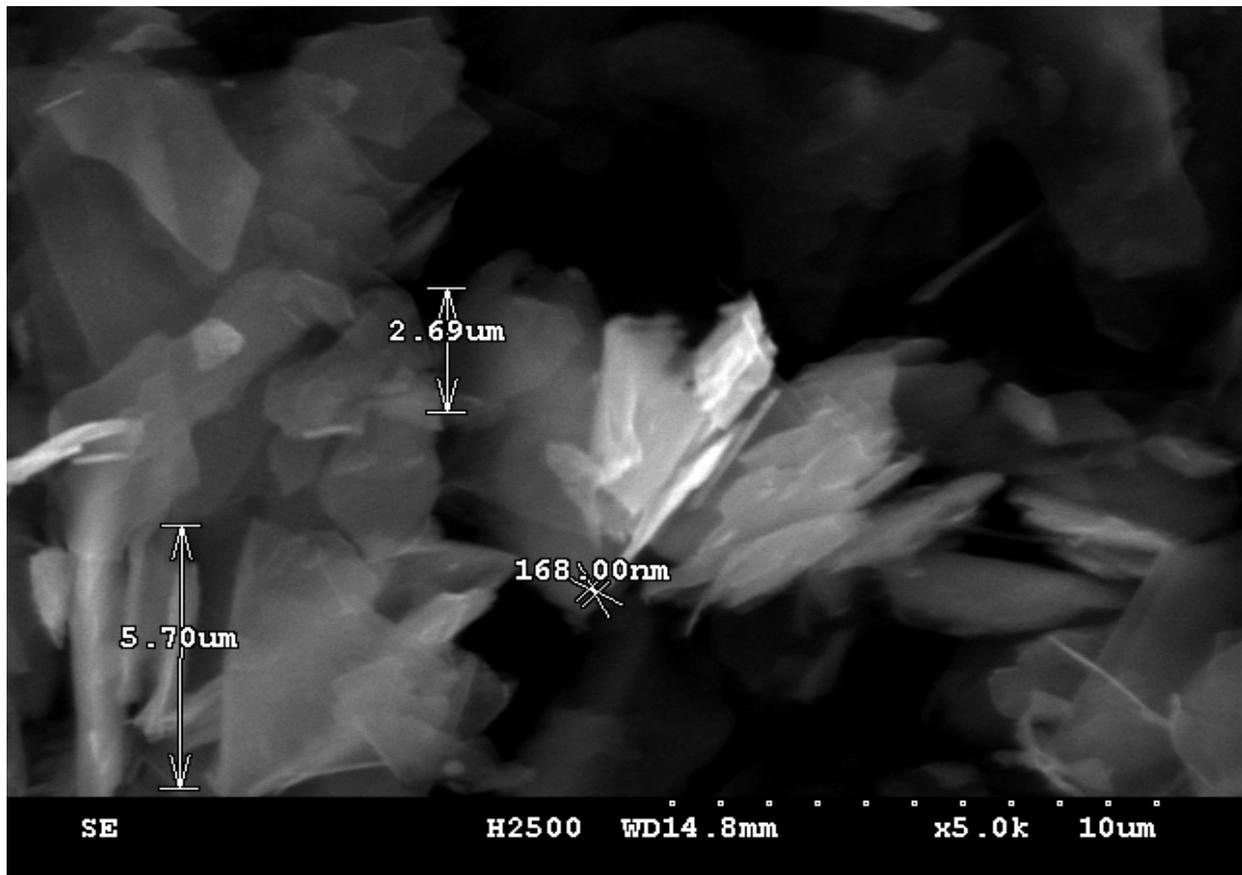
圖三 石墨粉 2500 目 電子顯微鏡(SEM) 5000 倍放大圖
