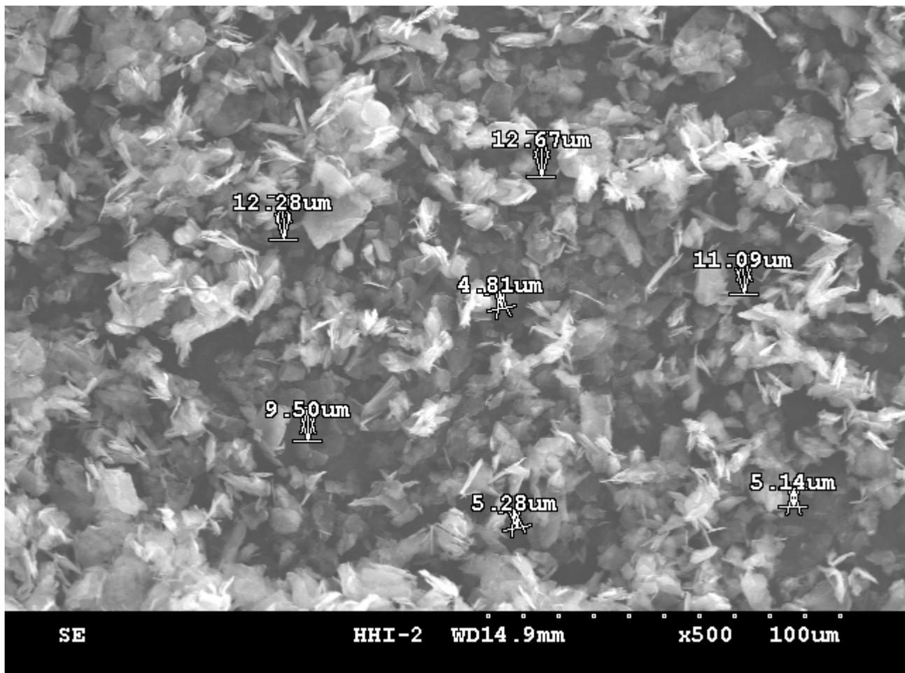
圖一 石墨粉 2500 目 電子顯微鏡(SEM) 500 倍放大圖
