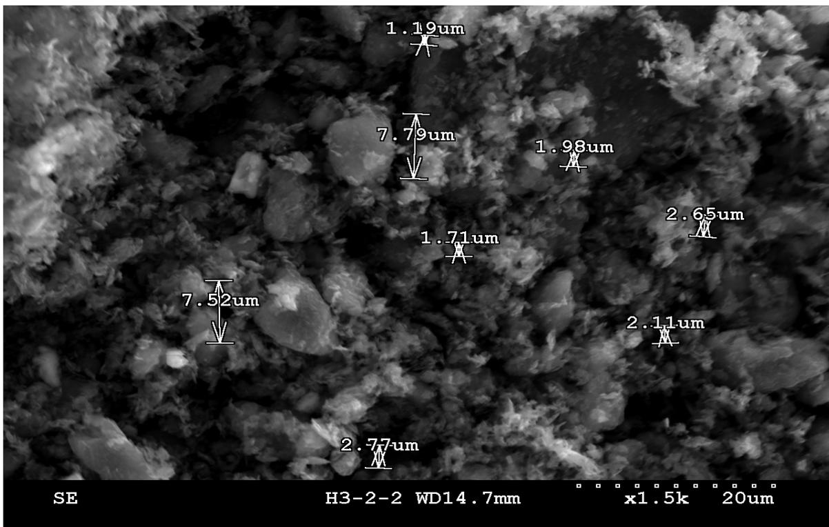
圖七 石墨粉 3.2micron 材質 電子顯微鏡放大圖 1500 倍
