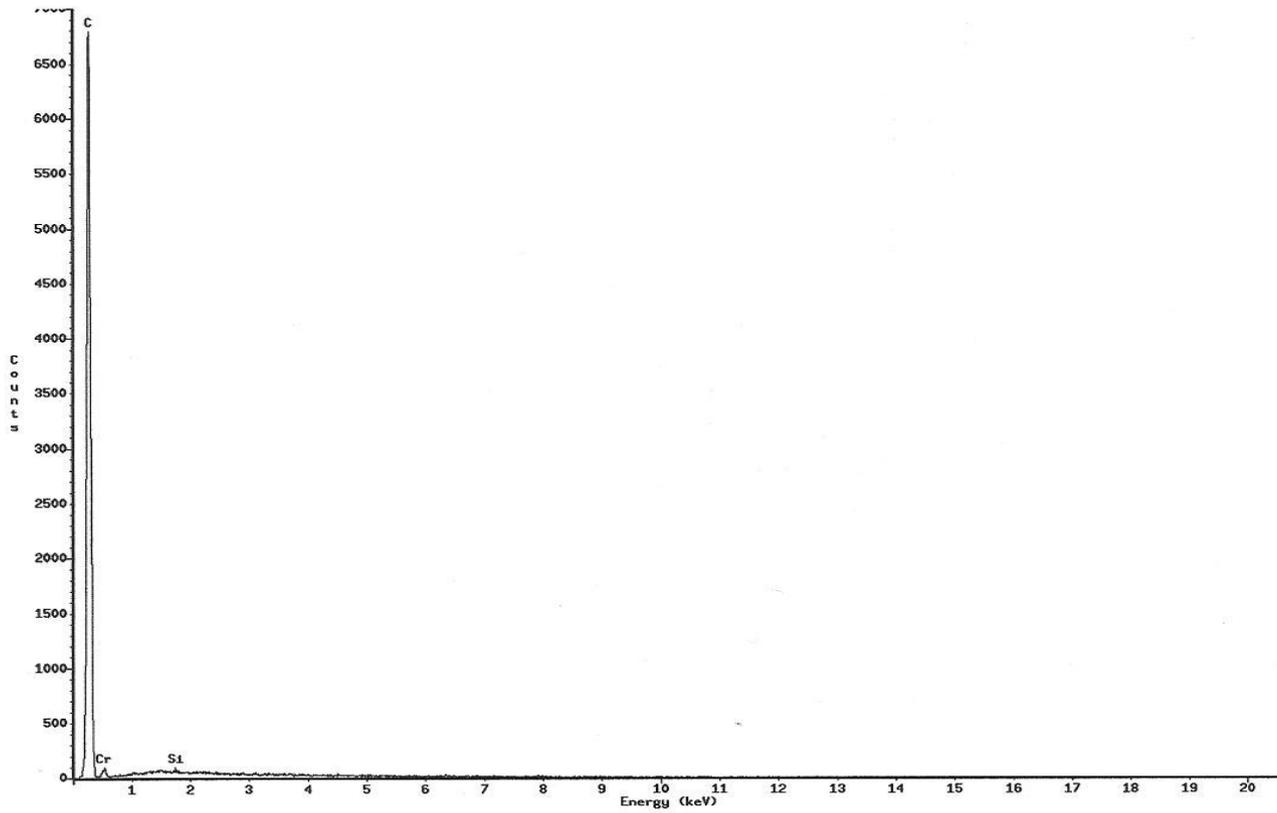
圖四 石墨粉 2500 目 材質分析圖(EDS)
