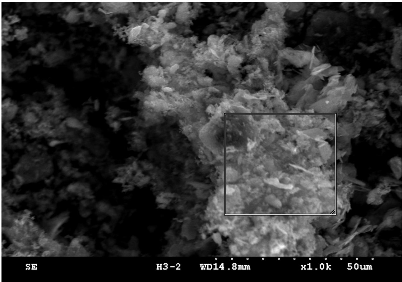
圖五 石墨粉 3.2micron 材質 電子顯微鏡放大圖 1000 倍
