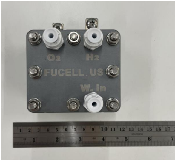
圖一:純水入口、氧氣+純水出口
